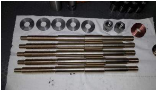
Renovation axes de blocage de munition
